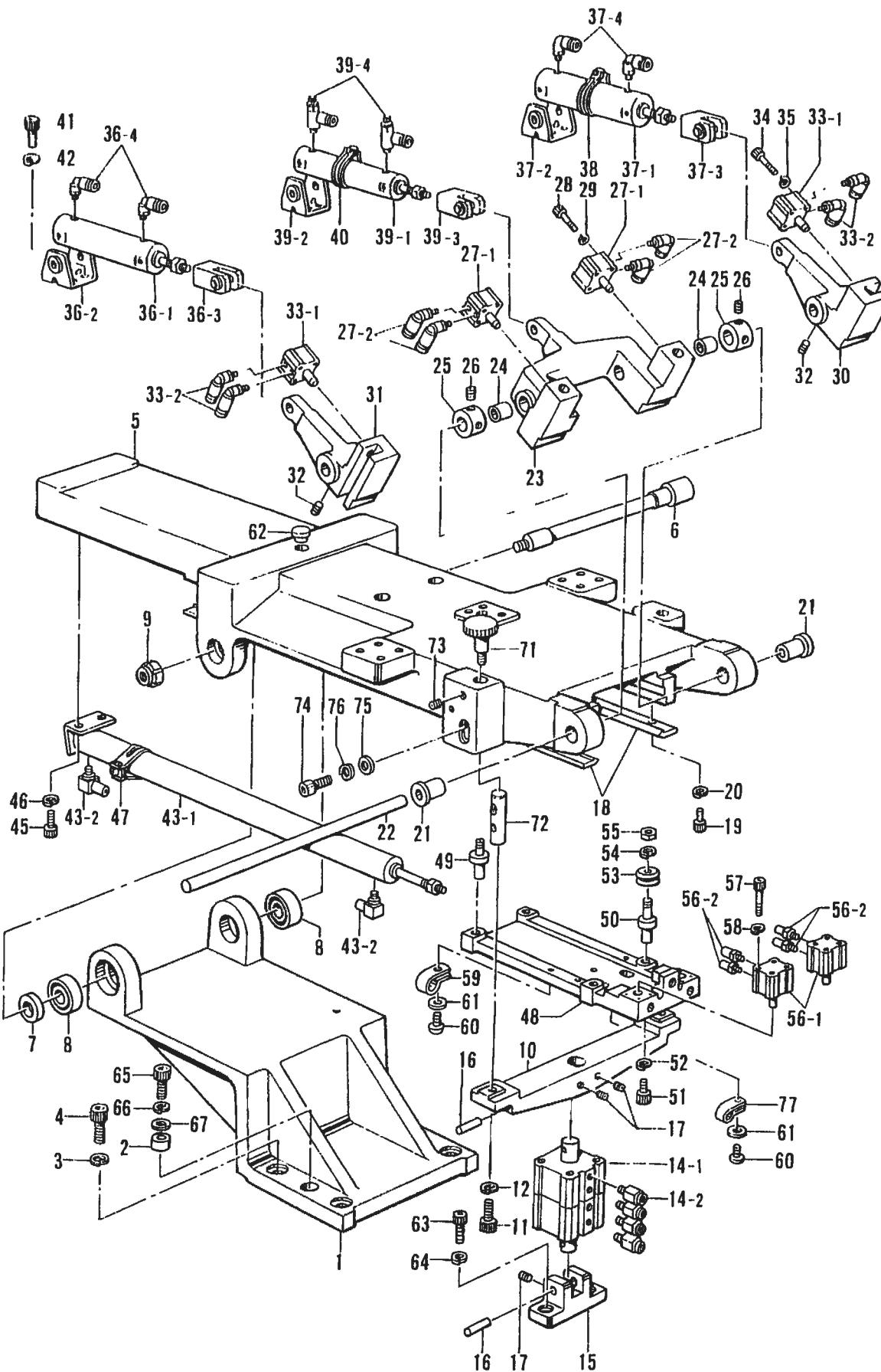
T. 折曲ゲ土台関係 / Folding margin base mechanism / Faltungsvorrichtungsgrundplatte /
