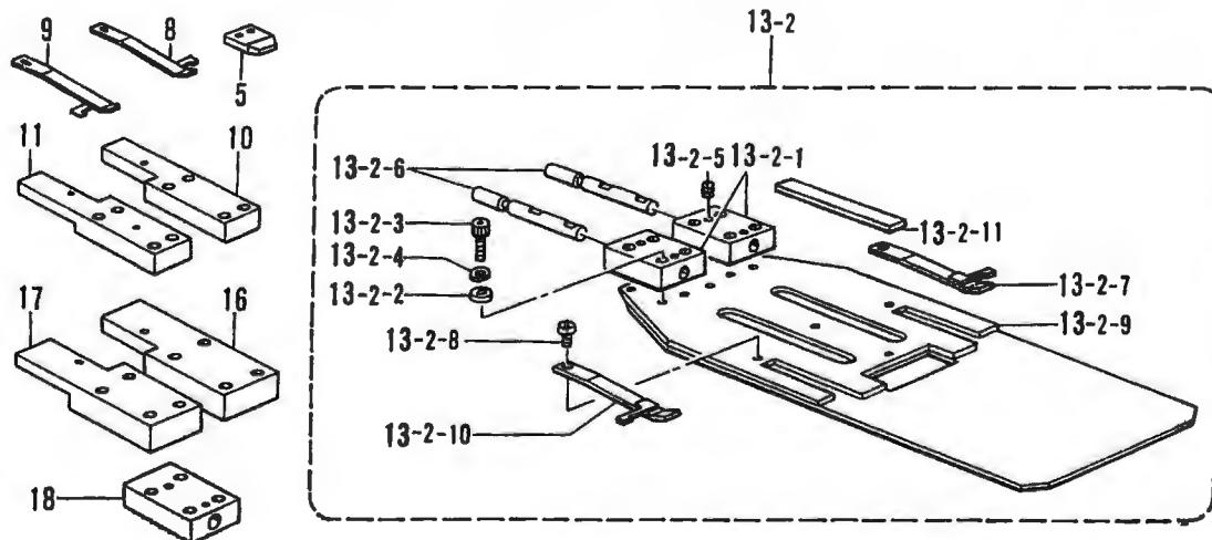
S. 折曲部品 (特別注文部品)/Folding margin mechanism (Option parts)/Faltungsvorrichtung (Sonderzubehör)/
