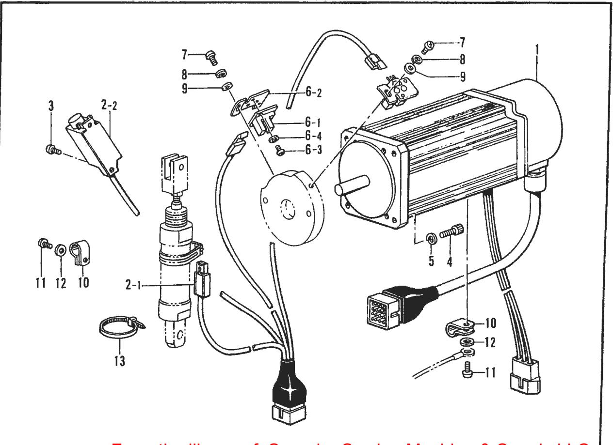
K. テンションリリース関係 / Tension release mechanism / Spannungsverminderungsvorrichtung /
