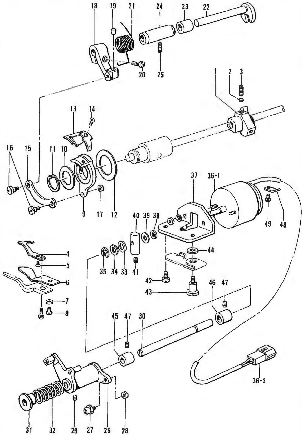
J. ホカリ関係 / Thread trimmer mechanism / Fadenabschneidevorrichtung /
