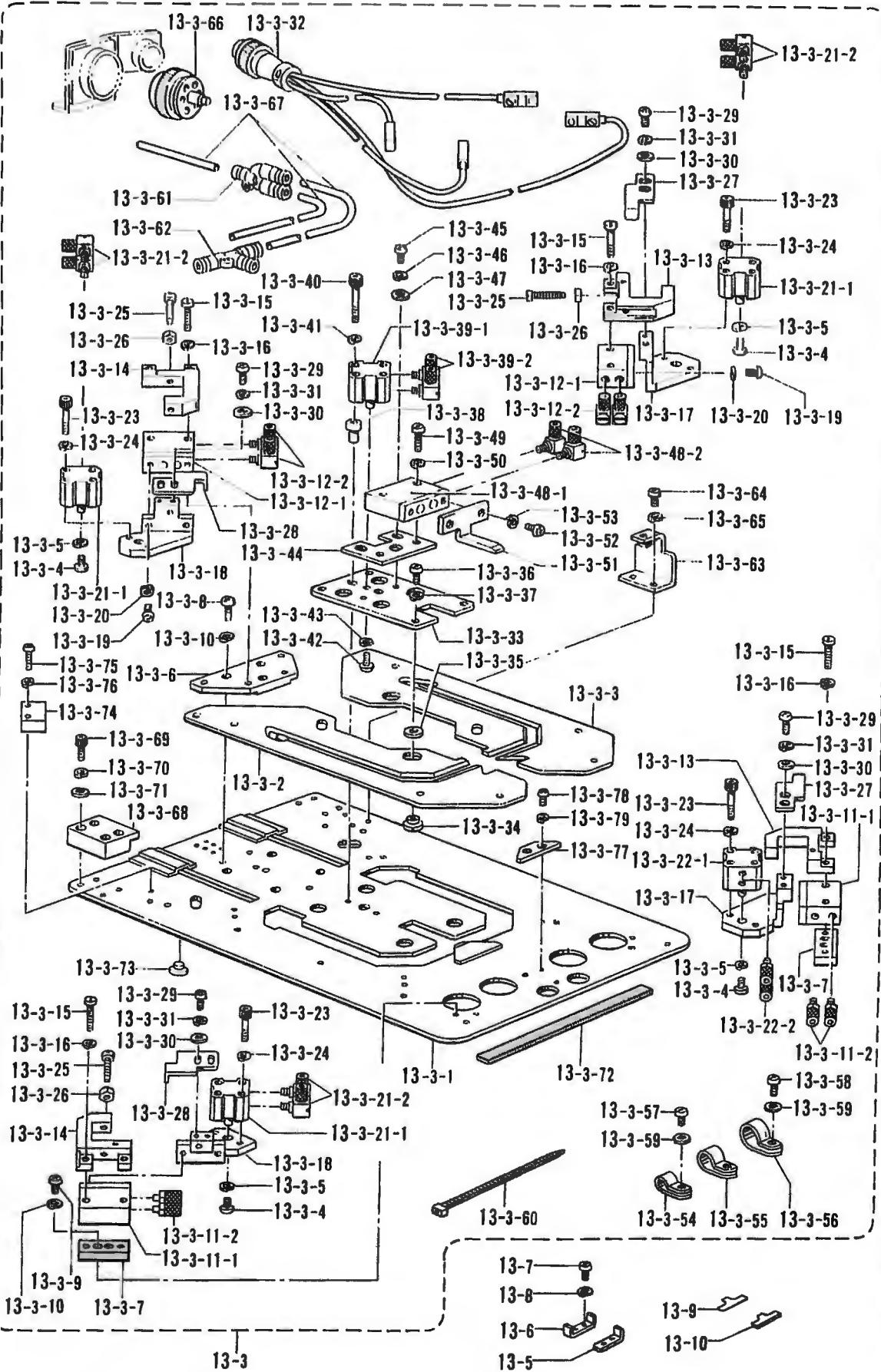
S. 折曲ゲル関係 (特別注文部品)/Folding margin mechanism (Option parts)/Faltungsvorrichtung (Sonderzubehör)/
