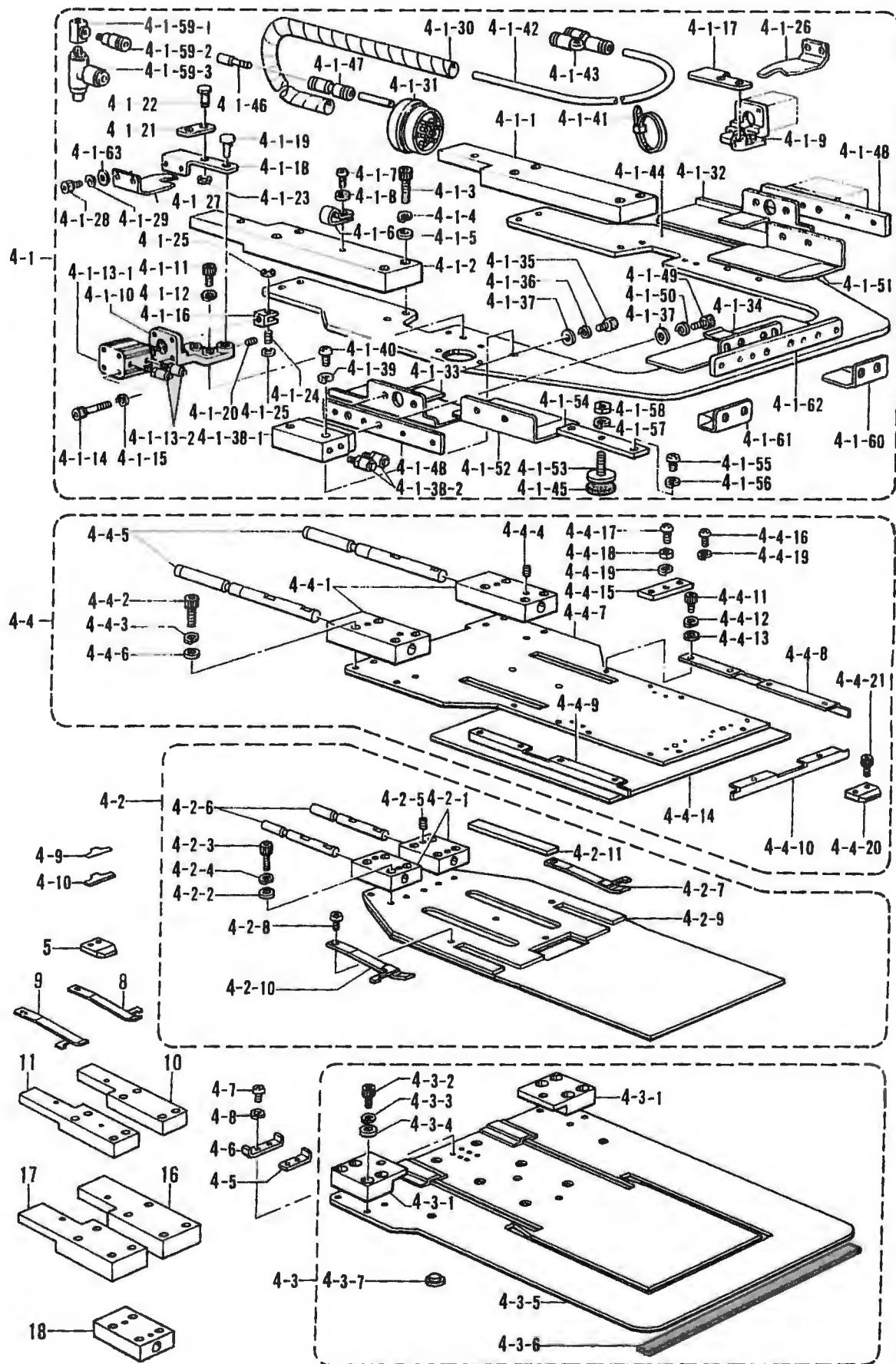
S. 折曲ゲ関係 (特別注文部品)/ Folding margin mechanism (Option parts)/ Faltungsvorrichtung (Sonderzubehör)/
