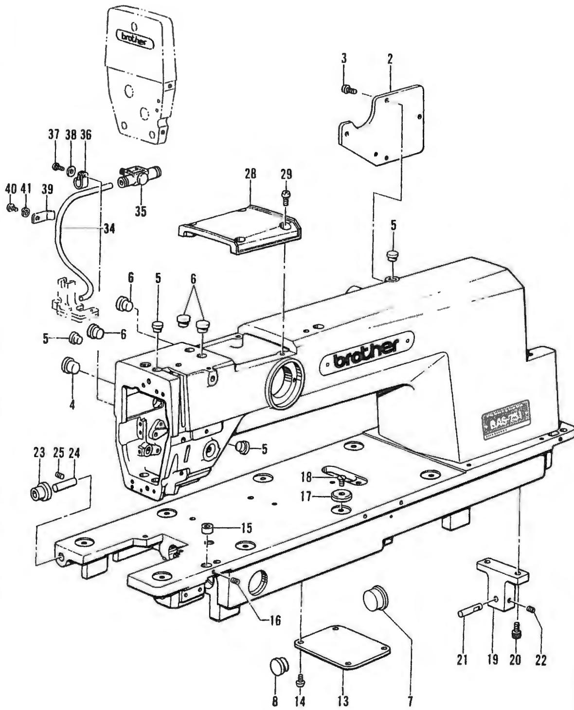
A. 主体関係/Machine body/Maschinengehäuse/
