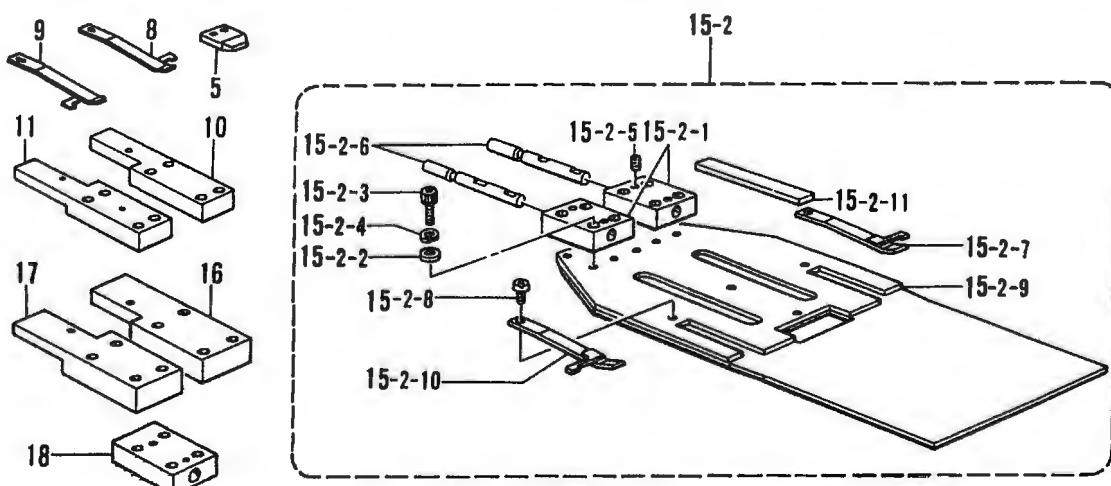
S. 折曲部品 (特別注文部品)/Folding margin mechanism (Option parts)/Faltungsvorrichtung (Sonderzubehör)/
