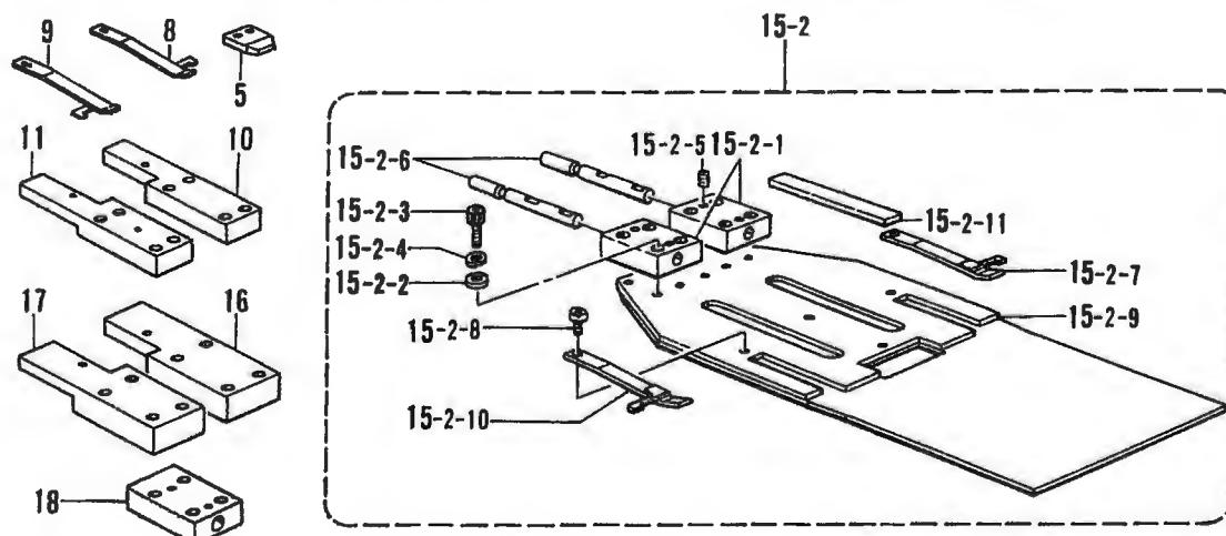
5. 折曲り 開脚 (特別)注文部品 / Folding margin mechanism (Option parts) / Faltungsvorrichtung (Sonderzubehör) /
