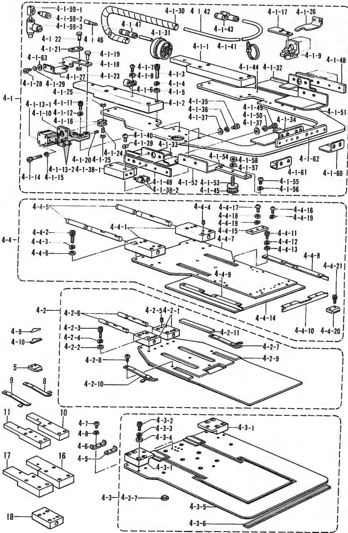
S. 折曲部品 (特別注文部品)/Folding margin mechanism (Option parts)/Faltungsvorrichtung (Sonderzubehör)/
