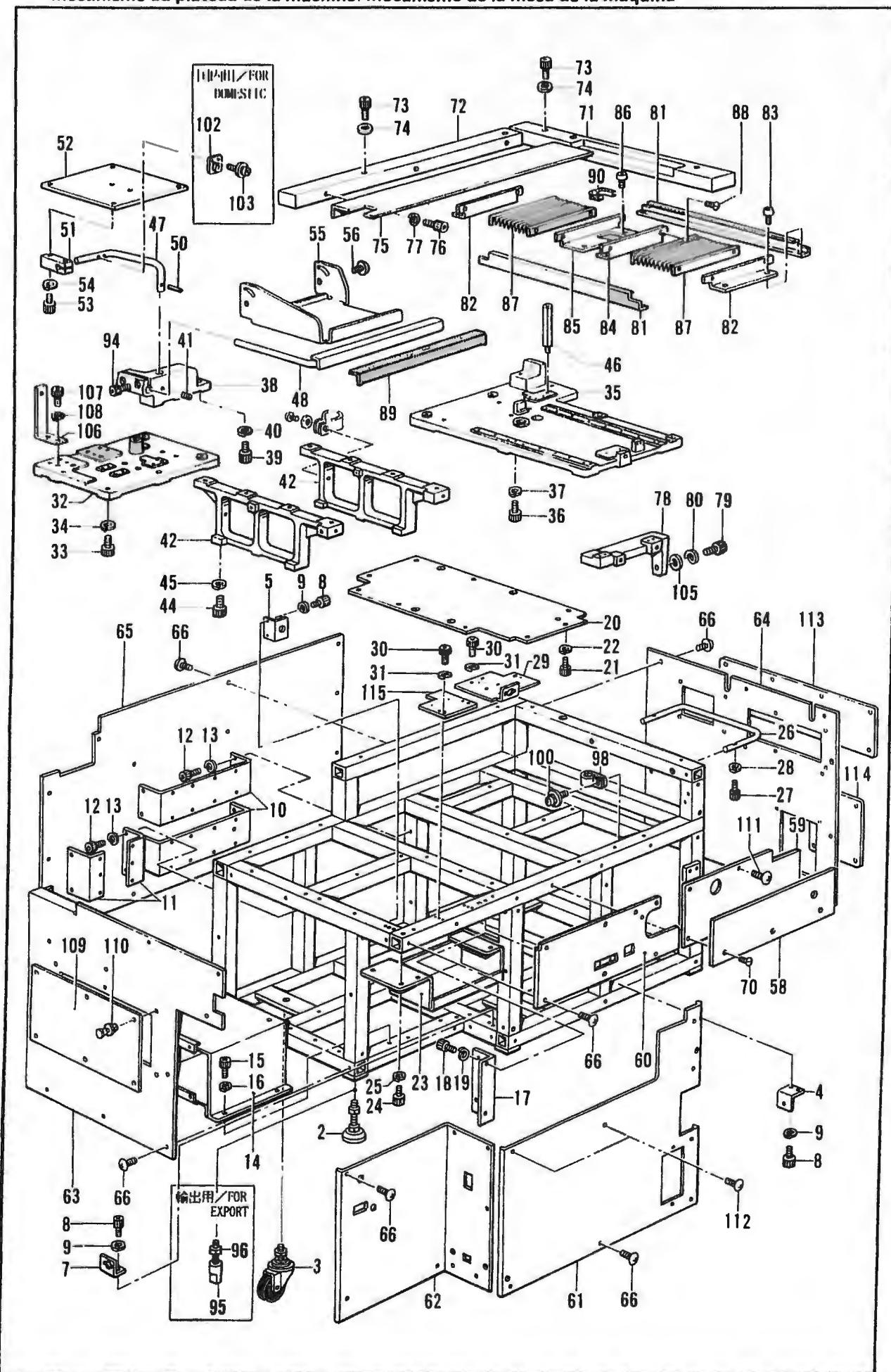
Mécanisme du plateau de la machine / Mecanismo de la mesa de la máquina
