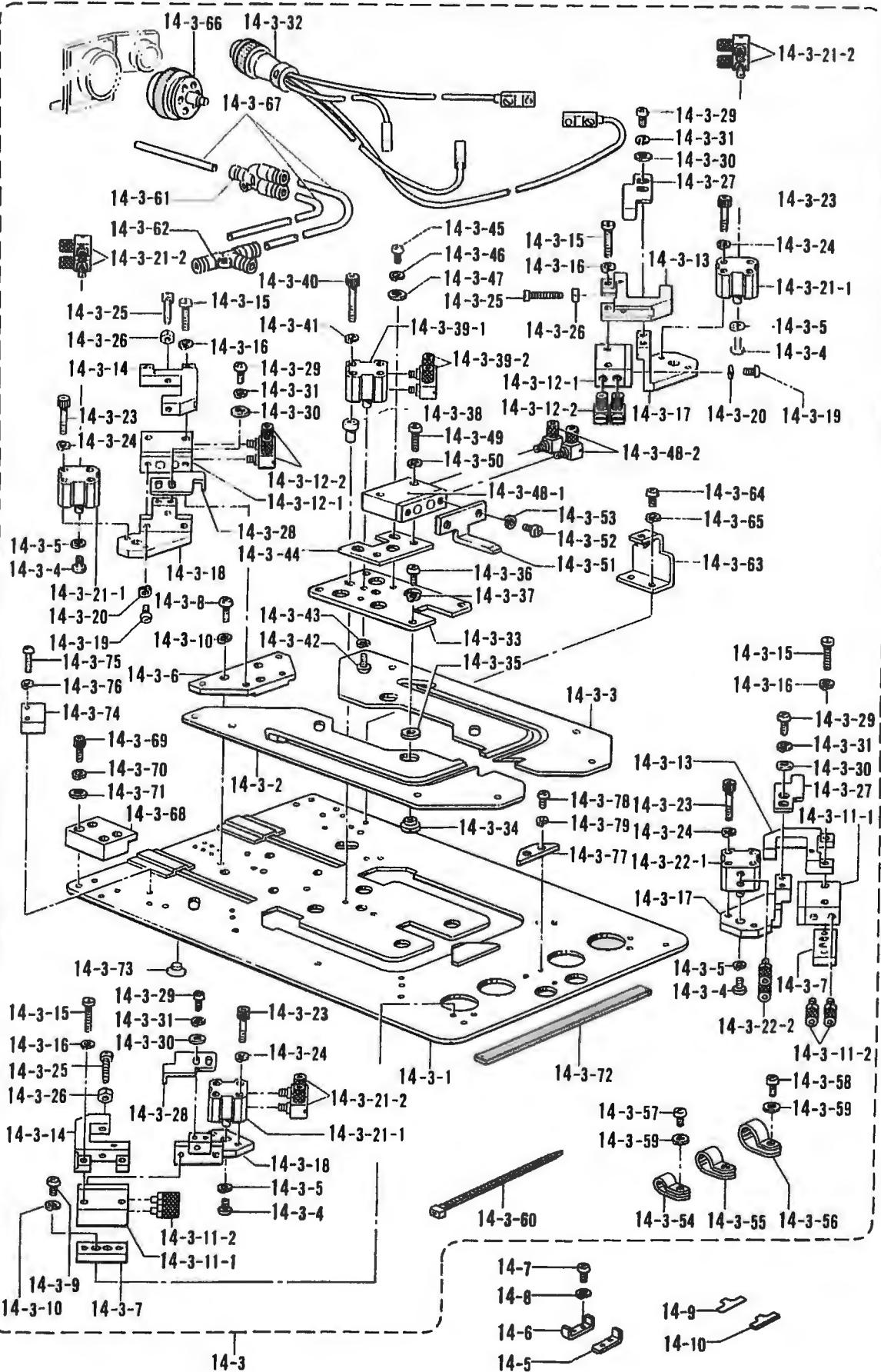
S. 折曲ゲ闇係 (特別注文部品)/Folding margin mechanism (Option parts)/Faltungsvorrichtung (Sonderzubehör)/
