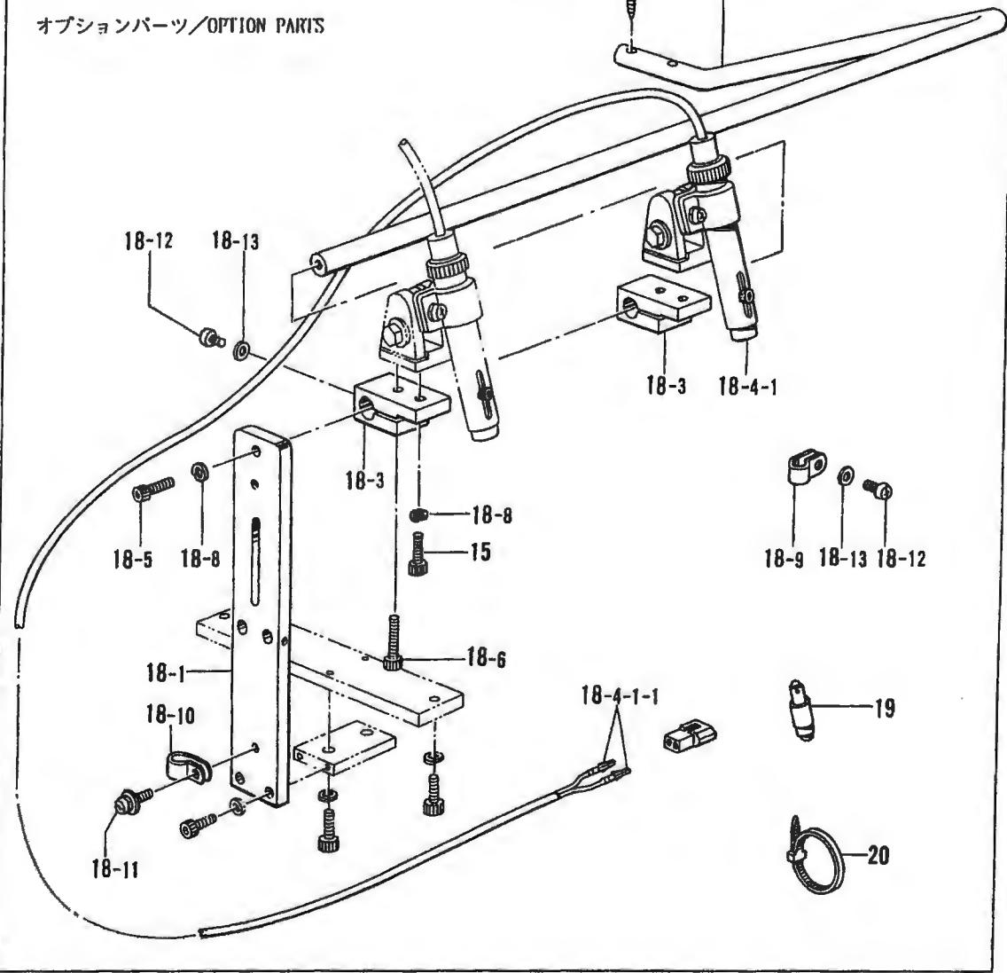
Mécanisme du marqueur/Mecanismo del marcador
