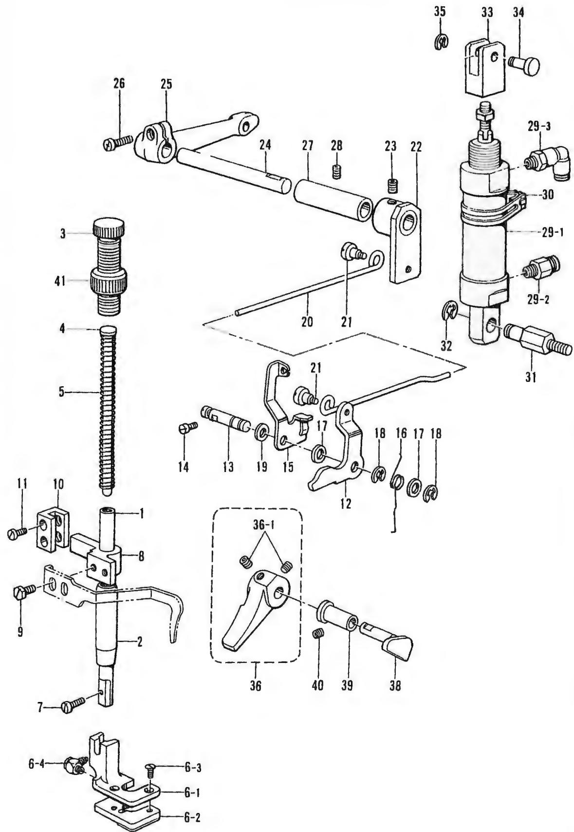
C. 押工関係/Presser foot mechanism/Stoffdrückerfuß/
