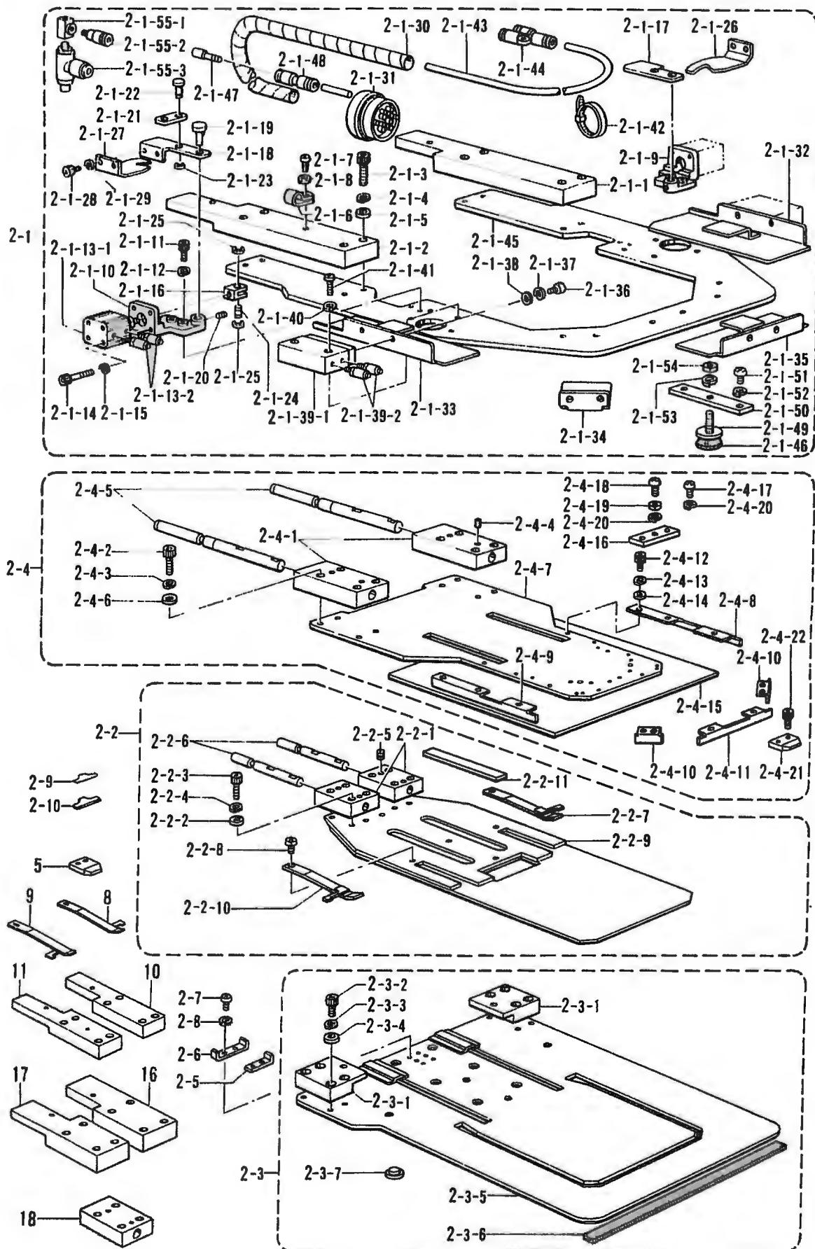
S. 机用部品(特別)王文部品/Folding margin mechanism (Option parts)/Faltungsvorrichtung (Sonderzubehör)/
