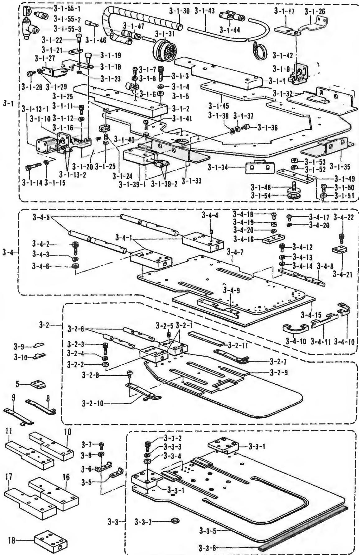
S. 折曲部品 (特別注文部品)/Folding margin mechanism (Option parts)/Faltungsvorrichtung (Sonderzubehör)/
